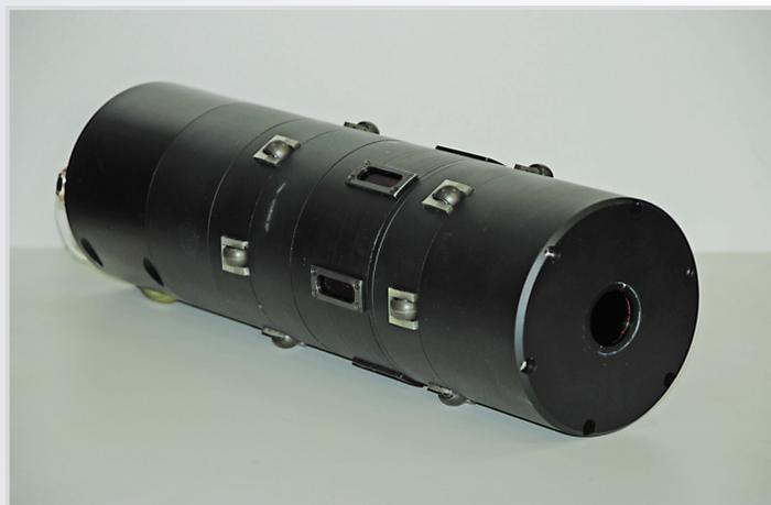
Приборы предназначены для измерения внутреннего диаметра (овальности) и отклонений от прямолинейности оси гладких штанг, труб и др. цилиндрических объектов.
