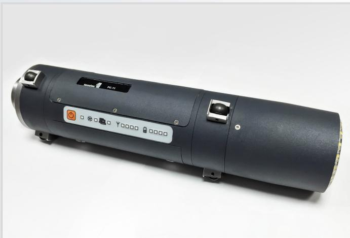
Автономный беспроводной прибор для видеоинспекции внутренней поверхности труб и других цилиндрических отверстий и изделий.
