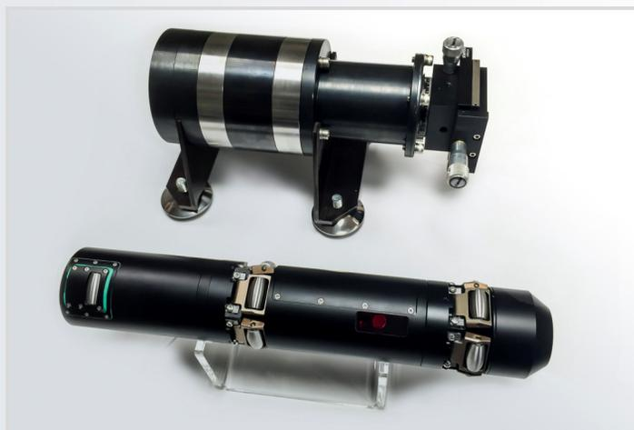
Лазерный прибор предназначен для измерения прямолинейности и лазерного сканирования профиля внутренней поверхности труб, а также для измерения внутреннего диаметра, овальности канала профилированных, нарезных труб от 55 мм.
