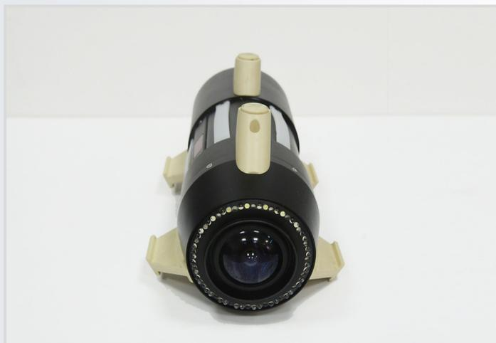
Прибор предназначен для видеоконтроля и лазерного сканирования профиля внутренней поверхности труб, а также для измерения внутреннего диаметра, овальности канала профилированных труб от 100 до 300 мм.
